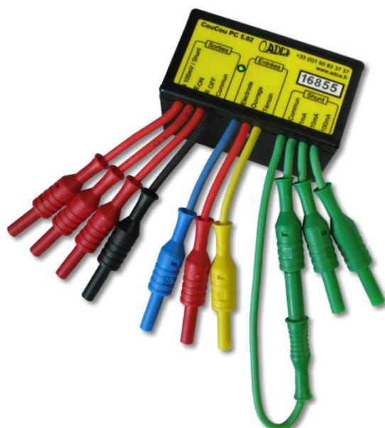
Cette appareil de mesure a été inventé par ADCA pour faciliter la mesure du potentiel de polarisation de l'acier par la technique du relevé du  $E_{OFF}$  sur coupon témoin.
