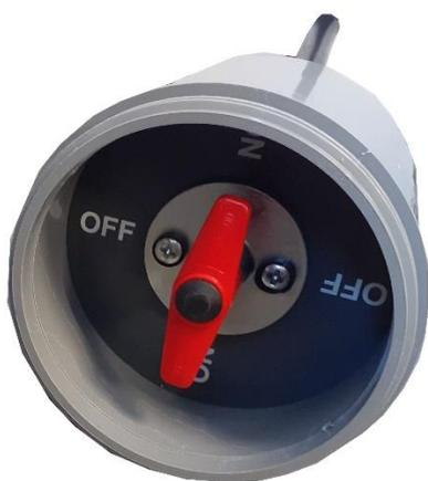
Ce sectionneur doit être mis en place sur la liaison RAIL en amont de l'armoire de drainage. Il permet découper l'alimentations RAIL pour effectuer un changement d'armoire ou permettre toutes autres interventions sur ce câble.
