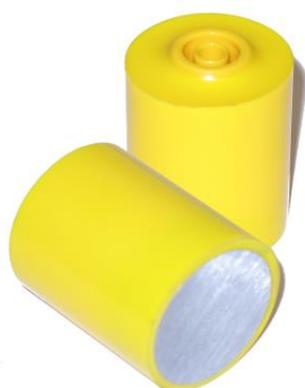
Les témoins amovibles permettent de faire des mesures et des enregistrements sur les ouvrages soumis à une protection cathodique.
