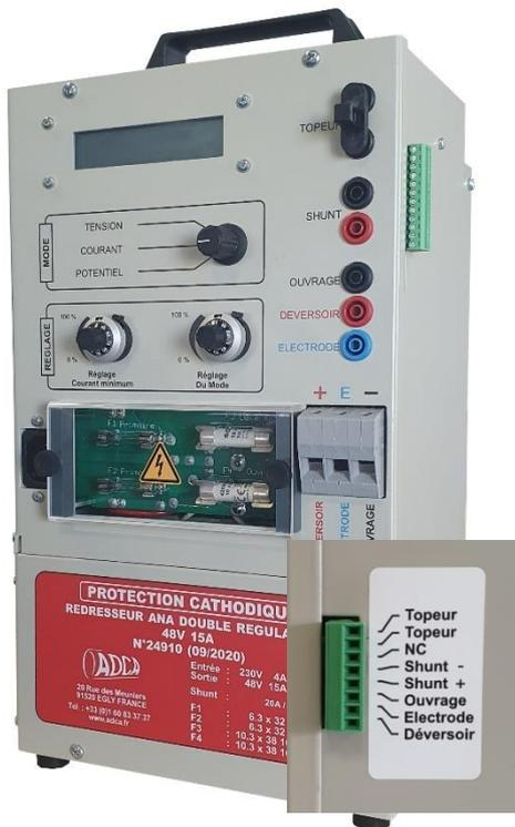
Ce redresseur autorégulé et basé sur la technologie du redresseur ANA possède deux boucles de régulation dont l'avantage est de permettre d'assurer l'injection d'un minimum de courant de protection cathodique en cas de défaut sur la première boucle de régulation.
