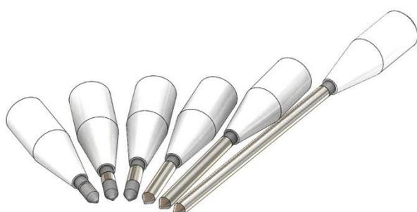
Le piquet est composé du témoin en acier XC 48 d'une surface exposée précise. Le témoin en acier se dévisse pour être changé rapidement. Le manche est en matière isolante et résistante et équipé d'une douille CEI1010.
