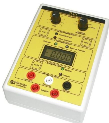
Le G.V.I. permet de calculer simplement la résistance d'isolement ( $\Omega m^2$ ) de votre ouvrage.
