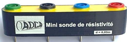
Dans le cadre de certaines mesures de protection cathodique, par exemple une mesure de potentiel, un technicien peut vouloir réaliser une mesure de résistivité.
