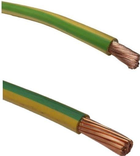
Le câble isolé vert jaune est le conducteur normalisé utilisé pour les liaisons d'installations électriques à la terre. Le câble souple est composé de fils multibrins, afin de permettre la souplesse du conducteur, pour le semi-rigide, le nombre de brins, à sections identiques, est moindre et de plus grand diamètre.
