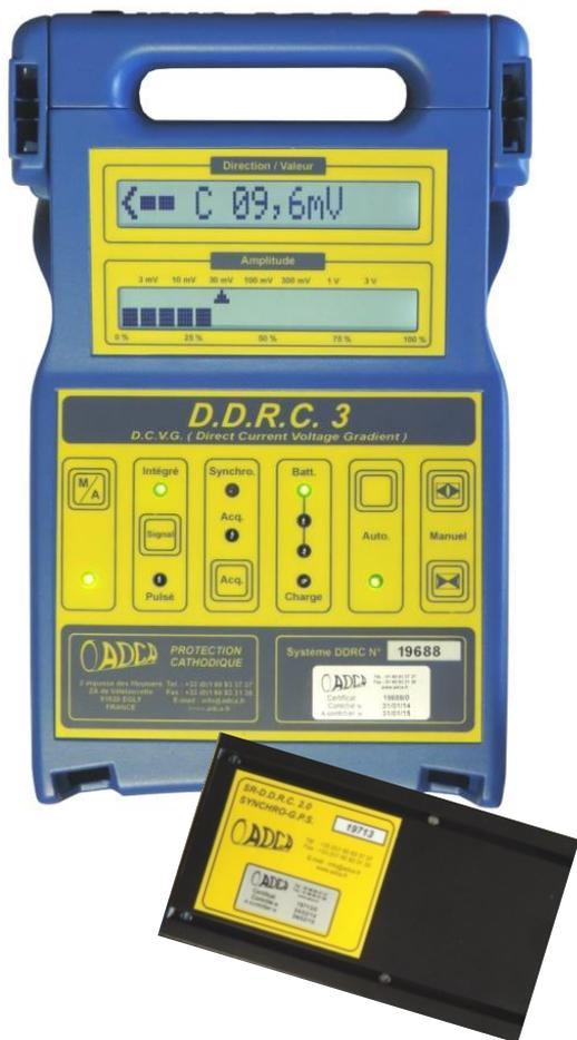
Le DDRC 3 est un détecteur de défauts de revêtement de canalisation fonctionnant selon la méthode DCVG (Direct Current Voltage Gradient).
